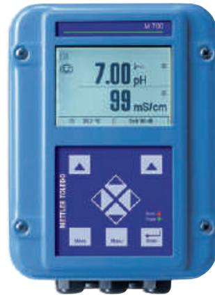
M700은 공정산업을 위한 멀티-파라미터 트랜스미터입니다. 세 개의 모듈 슬롯을 장착한 모듈형 설계로 사용자가 최대 두 개의 측정 파라미터를 설정할 수 있으며 더불어 통신의 선택도 가능합니다. 트랜스미터는 pH/ORP, 용존 산소, 가스 산소, 전도도 및 용존 이산화탄소 등의 측정 요건에 부합하도록 설정이 가능합니다. 트랜스미터는 고해상도 기능을 갖춘 백라이트 그래픽 디스플레이가 있으며 IP65/NEMA 4X입니다. 두 가지 인클로저 타입 중, 제약과 식/음료 산업을 위한 특수 처리된 스테인리스 스틸 제품과 화학 및 폐수 산업을 위한 코팅된 강철 제품을 사용할 수 있습니다.
